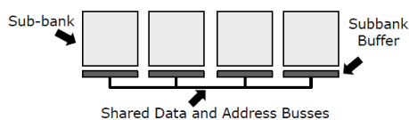
شکل (۱۵) استفاده از بافر نوشتن در بانک ثبات افزاز شده [۳۷]
