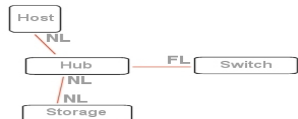
شکل ۴: کانال فیبری حلقوی اختیاری عمومی نوعی با هاب ۱۳
