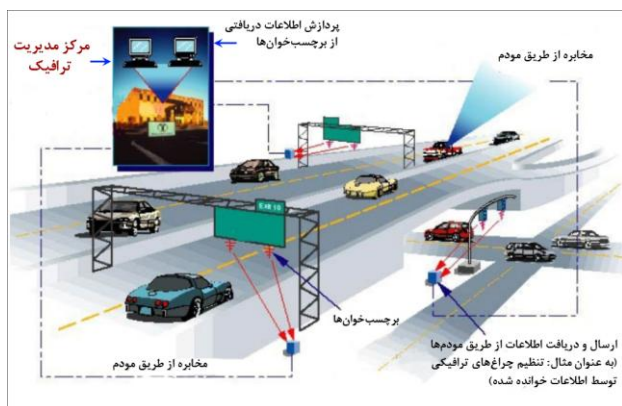
شکل (۹): سیستم کنترل تردد وسایل نقلیه مبتنی بر تکنولوژی RFID
