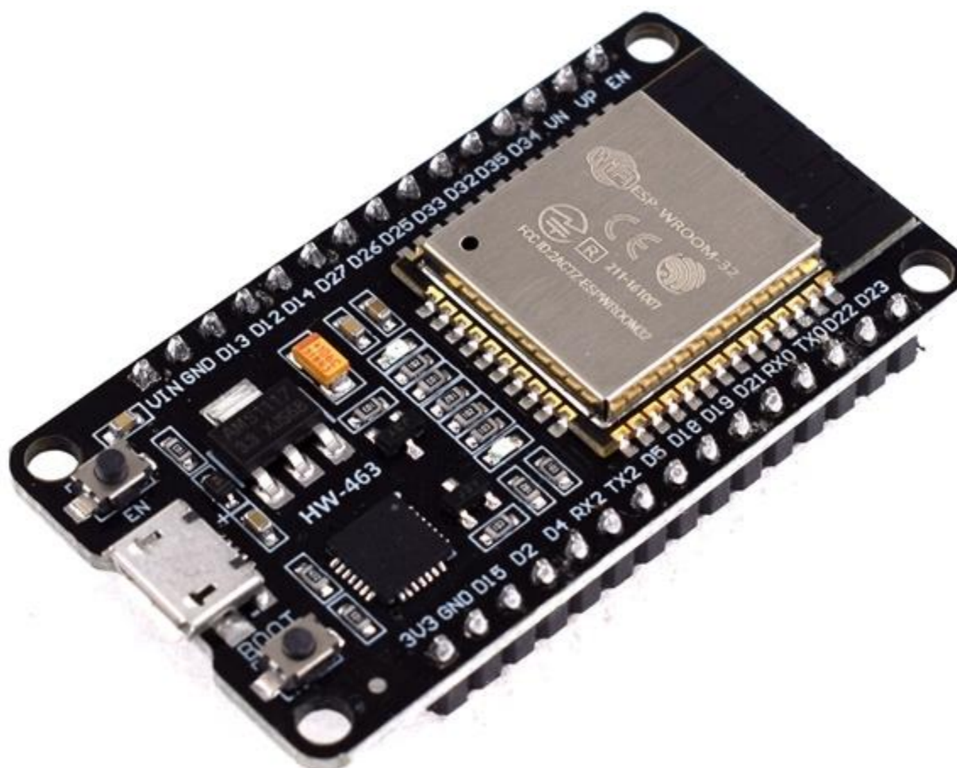
شکل ۱ برد ESP32 dev module برای تست و طراحی
