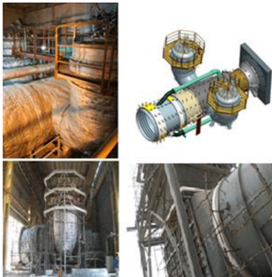
شکل ۱ عایق‌های ژاکتی و صوتی بخش‌های مختلف توربین‌های گازی
